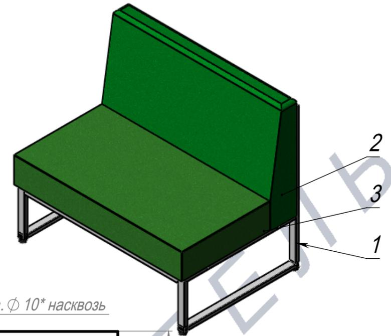
\*Стяжка с Диваном Лофт (если такое соединение предусматривается) происходит с помощью шпильки М6 DIN975 к.п. 8.8 L=80 мм и гаек Эриксона М6 через отверстия Ø10. Формула расчета количества шпилек для комплектации: Кол-во шпилек = 2×Кол-во Диванов Лофт. Формула расчета количества гаек Эриксона для комплектации: Кол-во гаек = 2×Кол-во шпилек.
